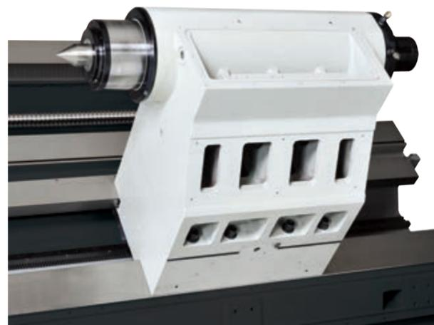
Punto giratorio MT6 estándar para una mayor rigidez durante la carga de piezas pesadas y eliminar la necesidad de puntos giratorios opcionales. Casquillo mejorado de  $\varnothing 200$  mm para la carga de piezas pesadas. Contrapeso de accionamiento hidráulico para un mecanizado más eficiente.
