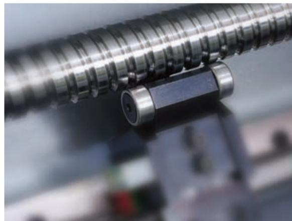
Soporte de husillo a bolas del eje Z en el modelo FBL-530/540, para una precisión y estabilidad óptimas.
